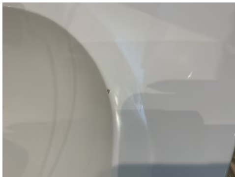
Avskalling på servant.
