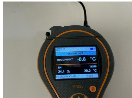
Måling relativ luftfuktighet. Målinger er foretatt fra inne i benkeskap på kjøkkenet uten å påvise unormale forhold.
