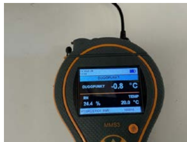
Måling relativ luftfuktighet. Målinger er foretatt fra inne i benkeskap på kjøkkenet uten å påvise unormale forhold.
