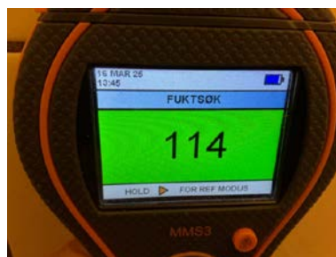
Det ble foretatt stikkprøvekontroll med Protimeter MMS3. Målingene viste ingen utslag utenfor normale verdier. Målingene gir kun en indikasjon og må ikke oppfattes som en garanti for baderommet.
