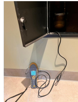
Fuktmåling i konstruksjonen for vaskerom.
