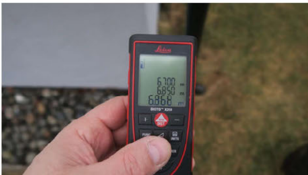
Måling UK sperre sydøst. Gesimshøyde er 28-31 cm høyere.
