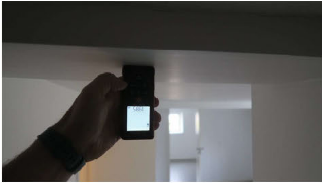
Mellom kjøkken og stue er høyden 1985 mm.
