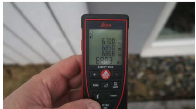
Måling UK sperre sydvest. Gesimshøyde er 28-31 cm høyere.
