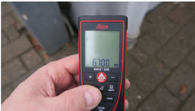
Måling UK sperre nordvest. Gesimshøyde er 28-31 cm høyere. Grensen i reguleringsplan er 700 cm. Grensen er således overskredet for flere av hjørnene.
