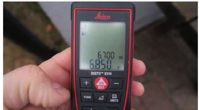
Måling UK sperre nordøst. Gesimshøyde er 28-31 cm høyere.
