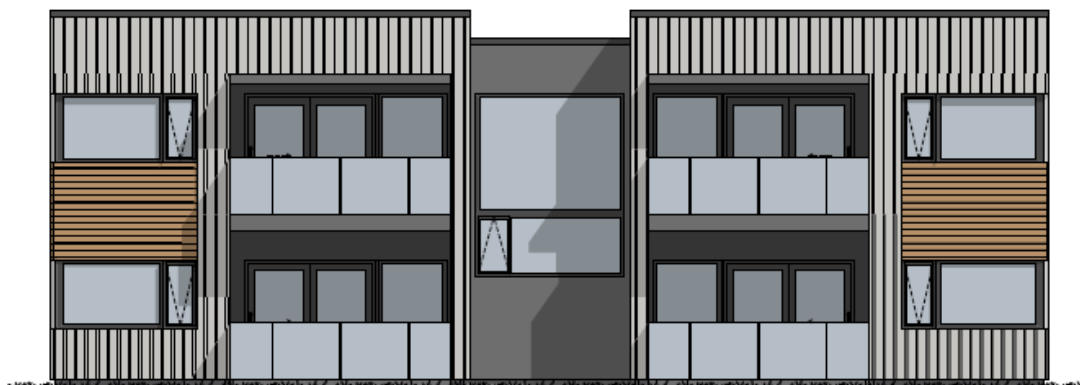
Fasadetegninger av firemannsbolig Kvartett. Over av front med balkong/terasser, og under av inngangsparti. Høyde over terreng er 6,45 m.
