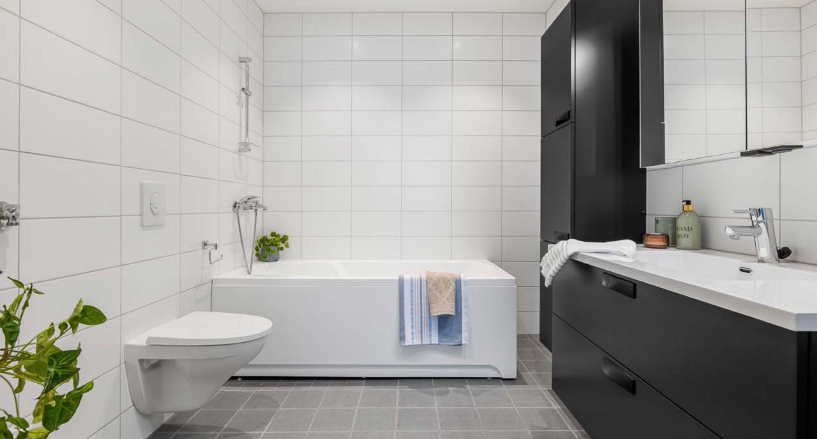
Begge badene har flislagte vegger og gulv med varmekabler i gulvet. Badet i 2. etasje har badekar med veggmontert dusjbatteri og veggmontert toalett.
