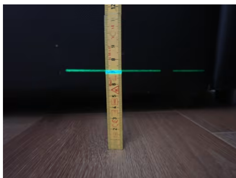
Referansenivå laser = 4 cm. Viser høydeavvik på 30 mm.
