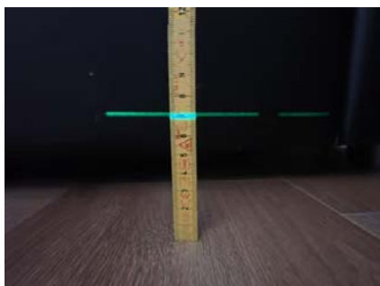
Referansenivå laser = 4 cm. Viser høydeavvik på 30 mm.
