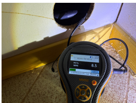
Fuktsøk viser ingen tegn til skader.
