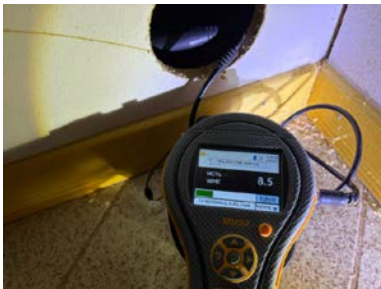
Fuktsøk viser ingen tegn til skader.
