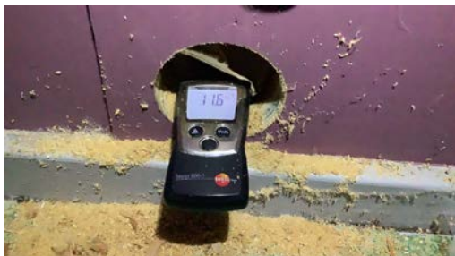
Hulltaking, og det måles tørt.
