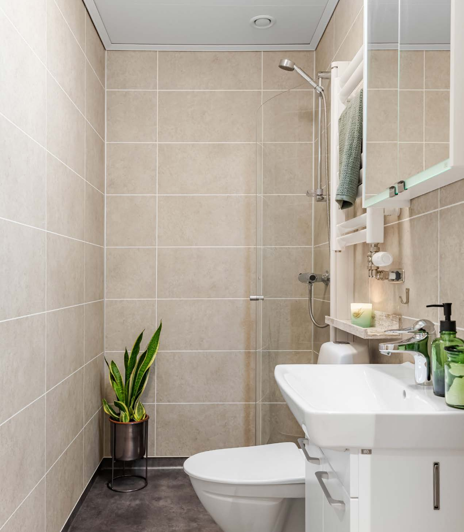
Baderom 2 er et pent baderom med våtromsbelegg på gulv, våtromsplater på veggene og avtrekk via balansert ventilasjon.
