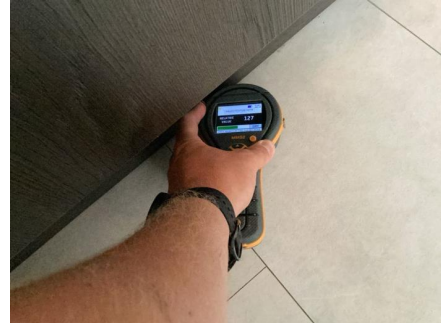
Ved bruk av fuktindikator registrerte jeg ingen unormale verdier.
