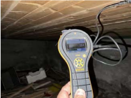
13,4% fukt i himling i krypkjeller er akseptabelt nivå og anses som tørt.
