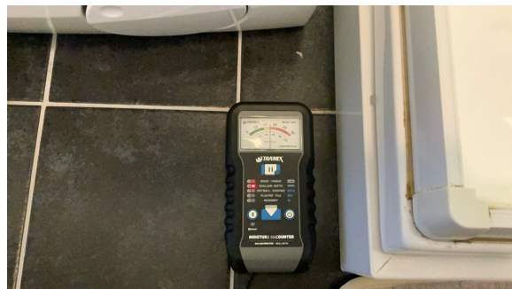
Fuktsøk på gulv/vegg i dusjsonen viser ingen unormale verdier. Det er målt referansepunkter andre steder i rommet enn i dusjsonen.
