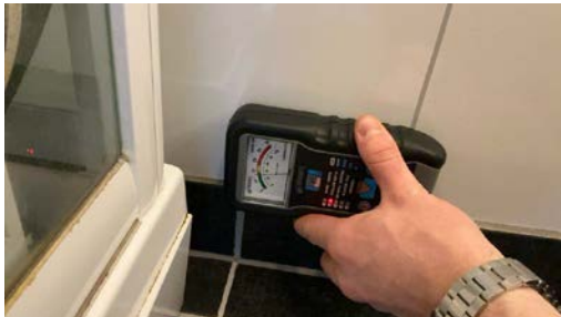
Fuktsøk på gulv/vegg i dusjonen viser ingen unormale verdier. Det er målt referansepunkter andre steder i rommet enn i dusjonen.
