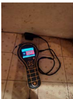
Ved fuktmåletaking var det fuktutslag i tilfarergulv
