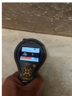
Saltutslag på yttervegg i kjeller
