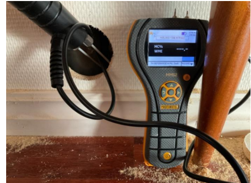
Fuktmåling i vegg.
