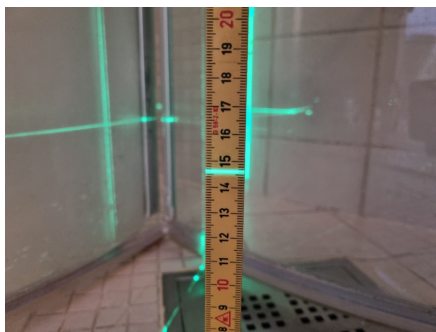
Topp sluk i dusj- 25mm høydeforskjell
