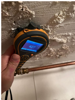
Det blir foretatt fuktsøk mot himling fra fyrrom her måles det forhøyet fukt.
