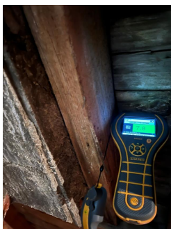
Det blir foretatt fuktsøk mot himling fra fyrrom her måles det forhøyet fukt.
