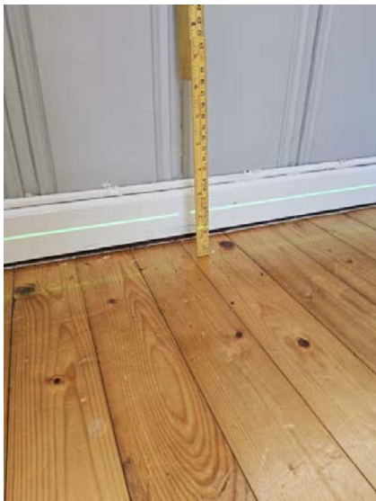
Bilde viser måling av etasjeskiller.
