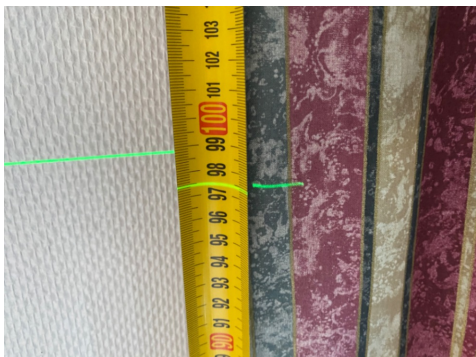
Måling av planavvik innenfor 2. m.
