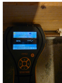
Fukt måling er utført med MMS2 og er korrigert for nordisk treverk.
