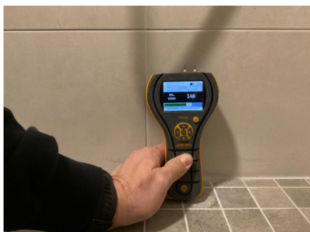
Fuktmåling på overflate i dusjsone
