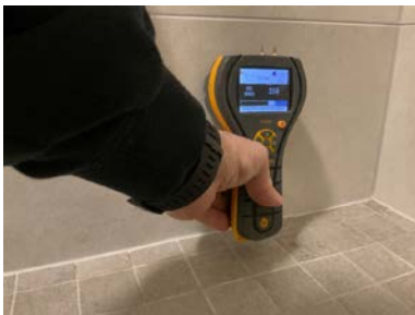
Fuktmåling på overflate i dusjsone
