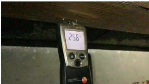
Det måles skadelig fuktinnhold i treverk i krypkjeller.
