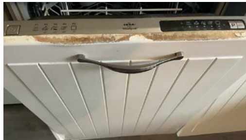
Fukt på front til oppvaskmaskin
