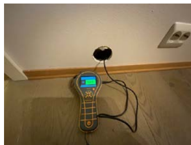
Hulltaking (73 mm.) er foretatt fra kjellerstue uten å påvise unormale forhold. Måleresultat: 10,6 %.
