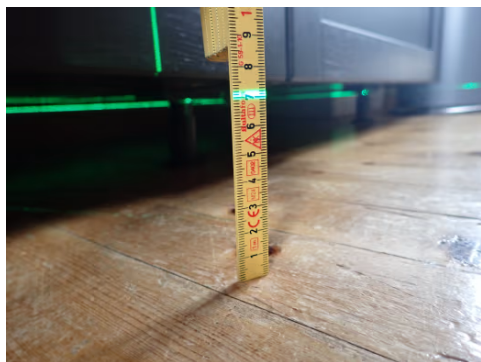
Måling i kjøkken. Referansenivå laser = 4 cm, og er målt innenfor 1 meters avstand.
