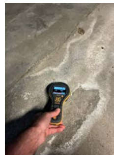
Saltutslag på gulv med utslag på fukt ved fuktsøk.
