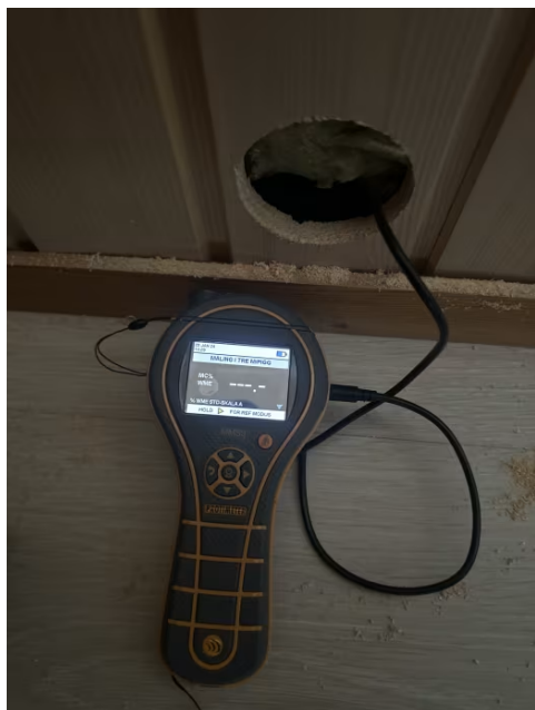
Det er foretatt hulltaking med 73 mm hullbor fra tilstøtende rom (gang). Undersøkelsen viser ingen tegn til skader eller fukt i konstruksjonen ved hull.
