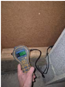
Målt vektprosent på 6,3% som er tørt tre.
