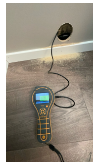
Hulltaking foretatt på soverom. Fuktmåling ble foretatt, jeg målte tørre verdier i konstruksjon.
