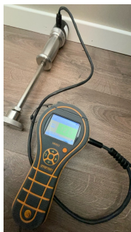
Fuktmåling ble foretatt, jeg målte tørre verdier i konstruksjon.
