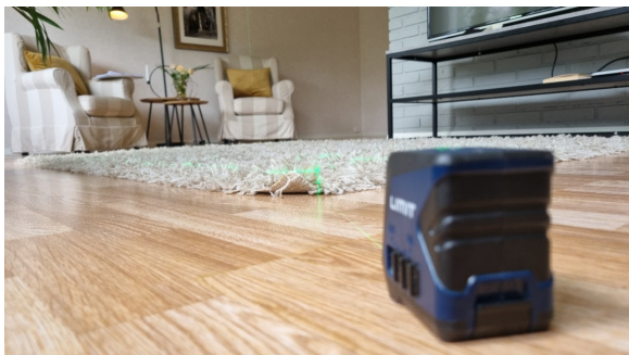
Kontroll av planavvik og skjevheter med krysslaser.
