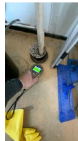
Ved bruk av fuktindikator registrerte jeg ingen unormale verdier.
