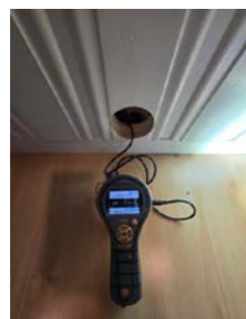
Fukt måling er utført med MMS2 og er korrigert for nordisk treverk.
