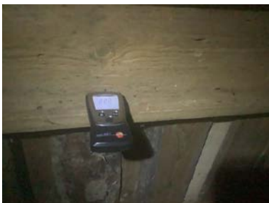
Det måles skadelig fuktinnhold i treverk i krypkjeller.
