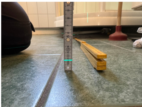
80 cm ut fra sluk 18mm (fall 11mm)
