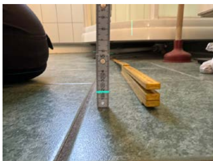
80 cm ut fra sluk 18mm (fall 11mm)
