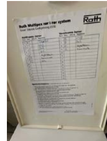
Kursoversikt for rør i samleskap
