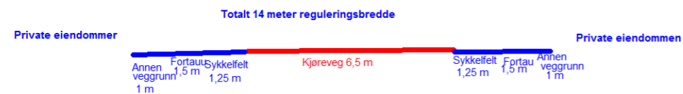
Figure 1: Prinsippsnitt for o_SKV9 med tilgrensende anlegg
