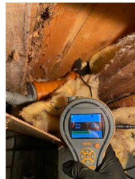
Fuktmåling uten unormale funn. 15,4 vektprosent.
