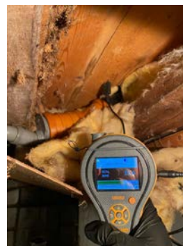
Fuktmåling uten unormale funn. 15,4 vektprosent.
