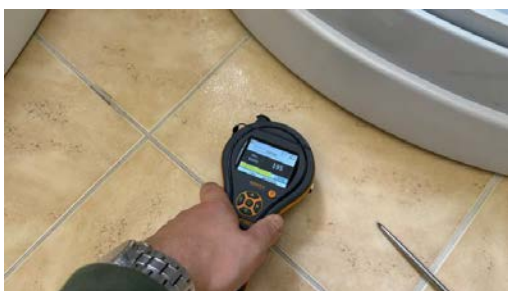
Det ble fuktmålt ved befaring, ingen unormale fuktverdier ble registrert.
