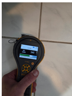
Fuktsøk er utført på gulv ved servant. Ingen forhøyde fuktavvik er målt
