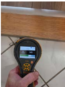
Fuktsøk er utført på gulv ved dørj. Ingen forhøyde fuktavvik er målt
