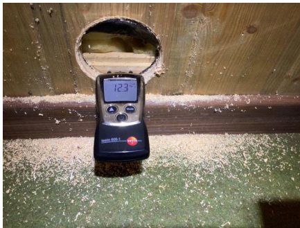
Hulltaking, og det måles tørt.
